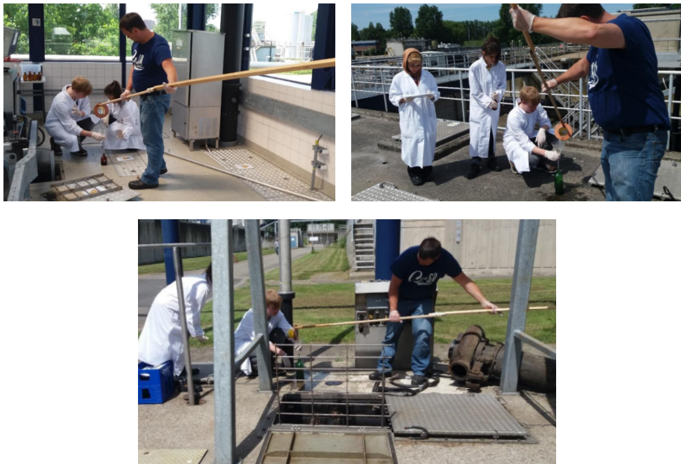
FIGUUR 19 DE HOUTEN STOK (VERSTELBAAR TOT 2,5 M HOOG) MET EEN HOUTEN VOET VOOR DE GLAZEN BEKERS (250 ML) DIE SPECIAAL ONTWERPEN IS VOOR DE "PLASTIC-VRIJE" MONSTERNAME
