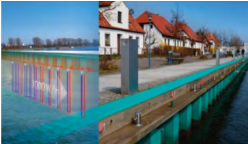
SCHEMATISCHE WEERGAVE VAN EEN THERMOGENIUS IN EEN KADECONSTRUCTIE (BRON: INDURIO)
