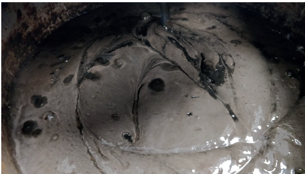
FIGUUR VI.25 THERMFILLY BEHANDELD SLIB GEMENGD MET GISTINGSLIB IN EEN GEKOELD VOORRAADVAT VERTOOND GEEN TEKENEN VAN GASPRODUCTIE EN BLIJFT LAAG IN VISCOSITEIT ZONDER INDIKKING GEDURENDE DE STANDTIJD
