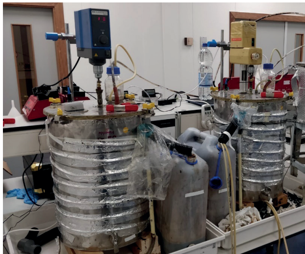
FIGUUR VI.6 DE OPSTELLING VAN DE CONTINU REACTOREN SCHEMATISCH (LINKS) EN IN DE PRAKTIJK (RECHTS) MET ROERWERK, GASUITVOER, PH- EN REDOXMETING EN GISTINGSSLIB OPVANG
