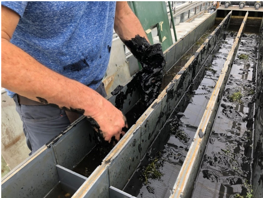
Figuur 4.22. Aanbrengen van slib met behulp van een spuitzak.
