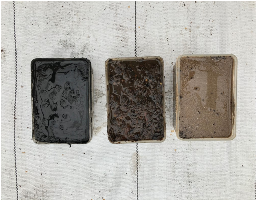
Figuur 4.21. Het sediment dat werd aangebracht in de compartimenten, van links naar rechts voedselrijk slib uit de Eefse beek, voedselarm slib uit de Renkumse beek en zand uit de Leuvenumse beek.
