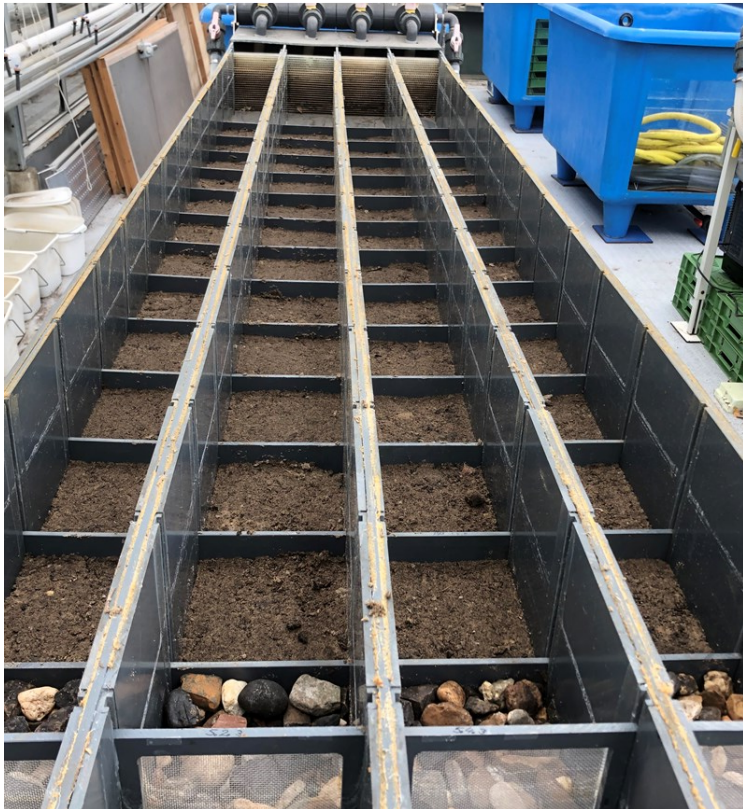
Figuur 4.18. Kunstbeek met vier stroomgoten met ieder 12 compartimenten gevuld met 2 cm zand uit de Leuvenumse beek. Ieder compartiment is 15 cm lang.
