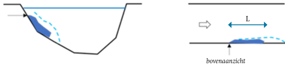
AFBEELDING 2.4 SCHEMATISCHE WEERGAVE VAN HET VERWACHTE GEDRAG VAN EEN KOUDEPLUIM IN STROMEND WATER MET IN DONKERBLAUW DE KOUDEPLUIM, IN STIPPELLIJNEN DE RAND VAN DE MENGZONE EN EEN L VOOR DE LENGTE VAN DE KOUDEPLUIM
