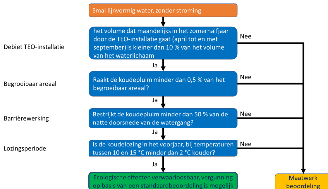
AFBEELDING 5.2 STROOMSCHEMA VOOR PEILGESTUURD SMAL LIJNVORMIG WATER ZONDER STROMING
