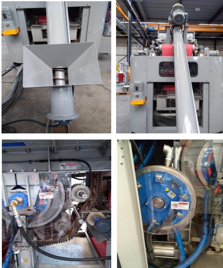
ONDERDELEN TESTINSTALLATIE; SCHACHT EN TOEVOERSCHROEF (BOVEN); BINNENKANT NEO (ONDER)
